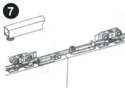
Зафиксируйте стальной трос со стороны крепёжного винта контргайкой и регулировочной удлиннённой гайкой на пластине для крепления троса. Протяните трос через паз поворотного ролика, проденьте его через отверстие фиксирующего винта. другой пластины, протяните трос через паз второго поворотного ролика. Проденьте его через отверстие фиксирующего винта первой пластины и натянув трос, зафиксируйте его крепёжными винтами.
