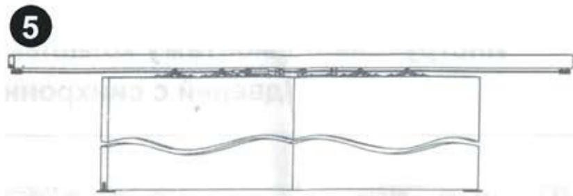
Крепежными болтами роликов отрегулируйте параллельность дверных полотен
