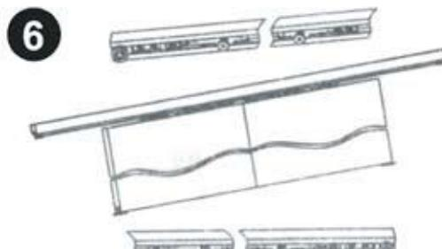
Зафиксируйте стопоры роликов в верхней направляющей.
