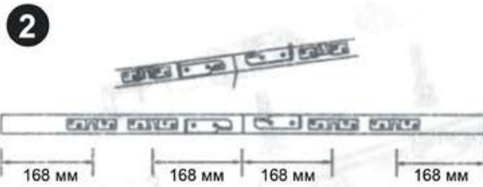
Закрепите навесные пластины и пластины для крепления троса к верхнему торцу полотна
