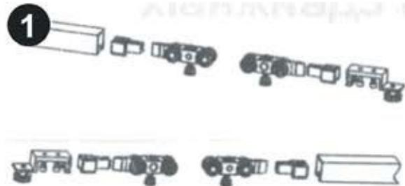
Поместите один за другим, стопор, ролики двери и поворотный ролик в верхнюю направляющую
