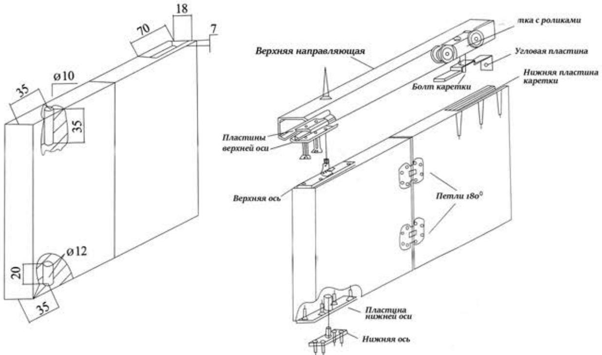
1. С верхнего торца двери на расстоянии 35 мм от края требуется просверлить отверстие диаметром 10 мм на глубину 35 мм. С этой же стороны, но с нижнего торца двери также на расстоянии 35 мм требуется просверлить отверстие диаметром 12 мм и глубиной 20 мм.
